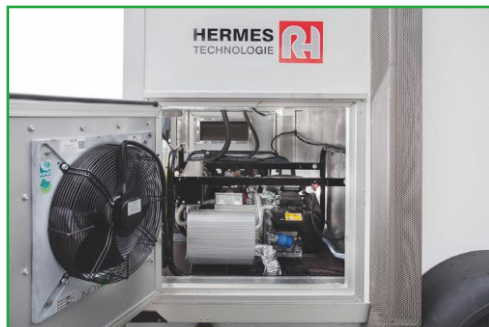
Motorový prostor s nucenou ventilací a vynikající zvukovou izolací
