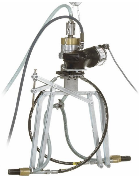
HDS-jet vysokotlaké tryskání pevnými částicemi s vodou
