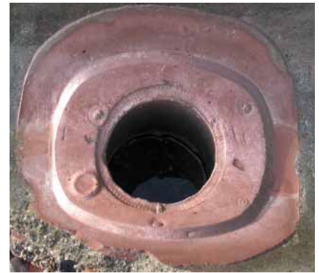
Bild 2: Getesteter Stutzen mit Ergelit-Kanaltec CF | Quelle: Hächler Umwelttechnik
